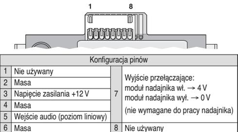
Podłączenie 7-pinowego gniazda na drukowanej płytce włącznika POWER nie jest wymagane.
